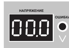
**ОШИБКА** - красный светодиод горит и издается звуковой сигнал, значит перепутана полярность подключения.
