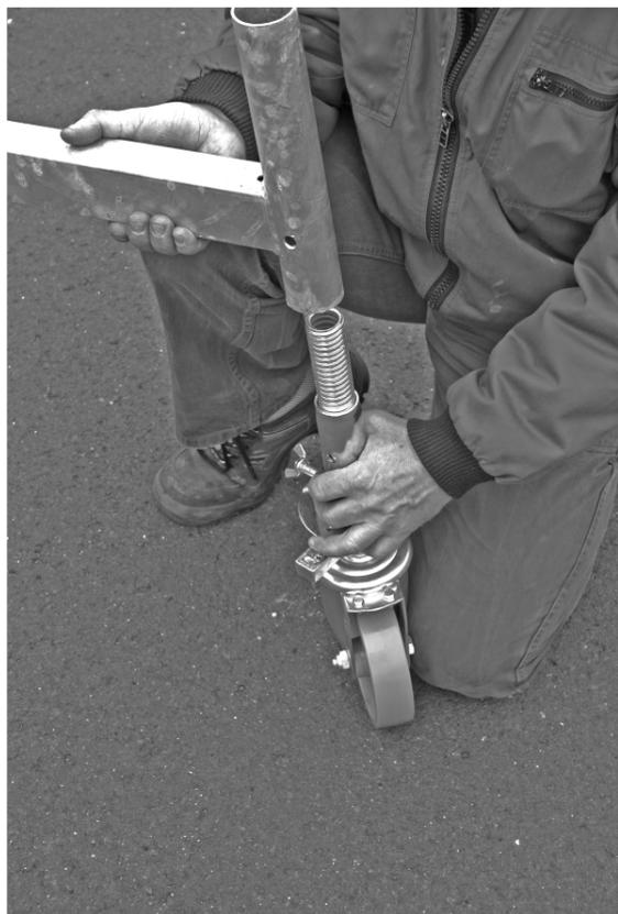
Затем, как показано на рисунке, вставьте ходовые ролики в опорные траверсы и закрепите их крыльчатыми болтами.
