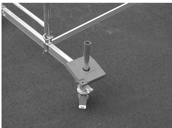
Оснащение траверс балластными грузиками
