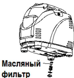
Рис. 10. Очистка масляного фильтра
