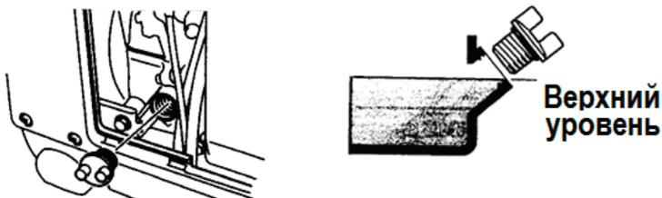
Рис. 5. Заправка генератора маслом
