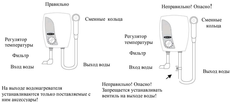
Схема 2. Установка водонагревателя.
