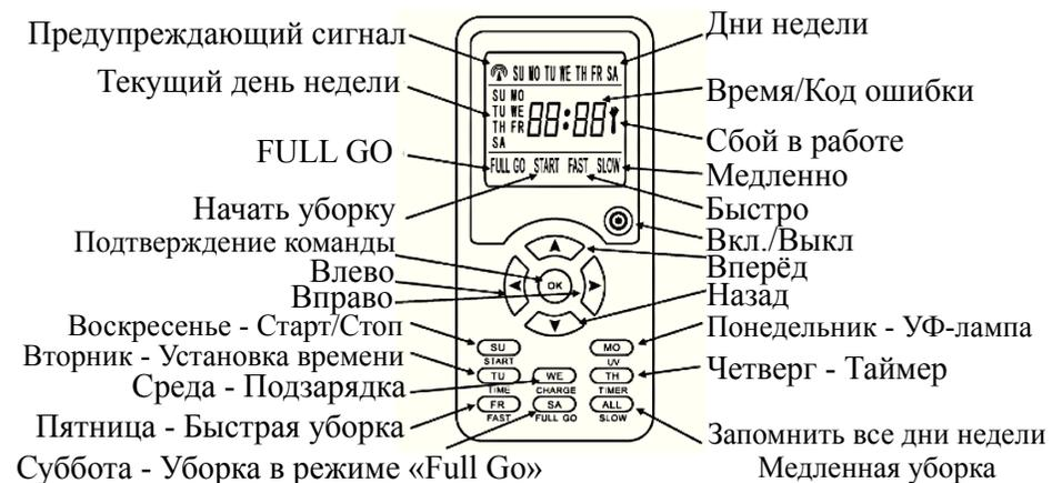
**Внимание!** Перед работой необходимо установить батарейки ( в комплект поставки не входят). Пульт ДУ работает от 2-х батареек типа ААА. Откройте крышку на обратной стороне пульта. Установите батарейки согласно полярности. В противном случае пульт можно повредить. Извлекайте батарейки из пульта, если он долго не используется.
