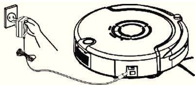
После полного заряда аккумулятора, не оставляйте робот-пылесос подключённым через адаптер более 4-х часов, это может привести к его повреждению.
