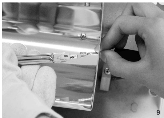
9. ПОДСОЕДИНИТЕ СОЕДИНИТЕЛЬНЫЕ РАЗЪЕМЫ НОВОЙ ЛАМПЫ ТИПА «ПАПА» К ДВУМ ПРОВОДАМ, НАТЯНИТЕ НА НИХ СИЛИКОНОВЫЕ КАПСУЛЫ И ВСТАВЬТЕ ЛАМПЫ НА ПРЕЖНЕЕ МЕСТО В МЕСТО РАСПОЖЕНИЯ ЗАЖИМОВ.
