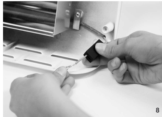
8. ВСТАВЬТЕ НОВЫЕ РАЗЪЕМЫ И ПРИЖМИТЕ ИХ В МЕСТЕ СРЕЗА ПРОВОДОВ. ВНИМАНИЕ: НЕ ДОТРАГИВАТЬСЯ ДО ЛАМПЫ ГОЛЫМИ РУКАМИ.
