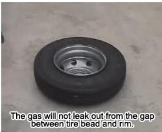
4) Теперь возможно наполнить шины соответствующим давлением непосредственно через выдувную трубку.
