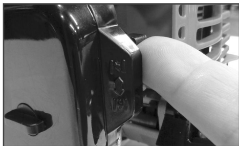
Рис.9 Закрытие воздушной заслонки
