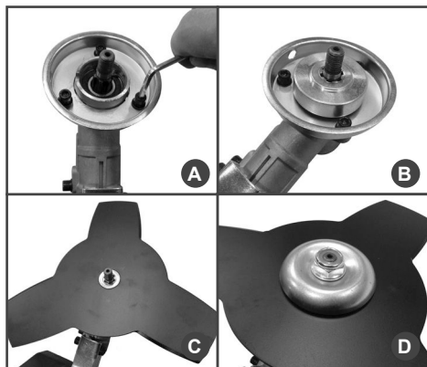
Рис.5 Установка ножа для травы
