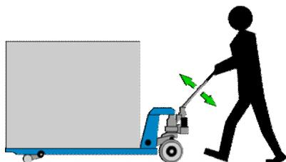
Груз поднимается при движении ручки гидравлической тележки.
