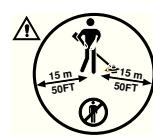
Машины с лезвием для пиления или для травы могут быть подвержены сильной отдаче, когда лезвие соприкасается с неподвижными твердыми предметами. Лезвие в состоянии отрезать руку или ногу. Следите за тем, чтобы на расстоянии 15 метров от машины не находились люди или животные.
