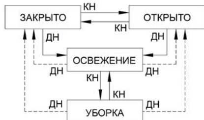
Рисунок 2. Схема управления системой с помощью кнопки. КН - короткое нажатие, ДН - длительное нажатие.
