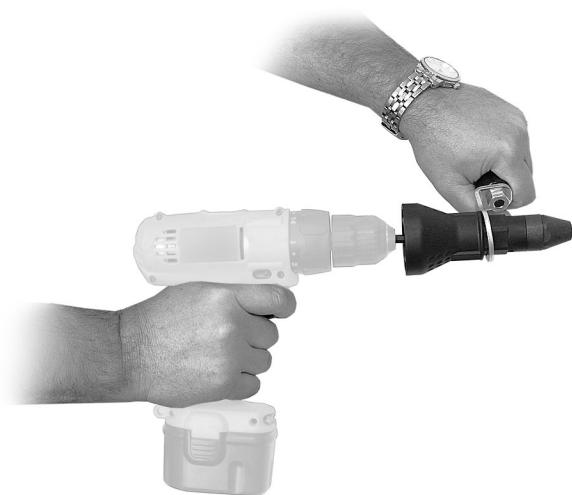
4. После выключения заклепочника установите заклепку в насадку и вставьте ее в отверстие скрепляемых материалов.
