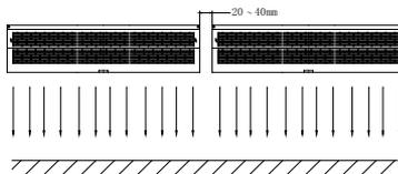
3.5 Не допускайте зазоров между агрегатом и опорой. При потолочном монтаже используйте дополнительное потолочное крепление.
