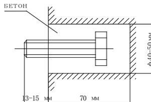
4.1.3 Как только цементный раствор затвердеет, закрепите монтажную пластину (используйте прокладку и гайку согласно схеме).
