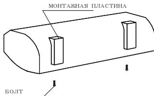
4.3.2 Зафиксируйте потолочное крепление, см. рисунок ниже:
