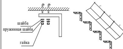
4.3.3 Установите монтажную пластину на потолочное крепление и убедитесь в надежности крепления (используйте болты, ввинченные в потолочное крепление, как показано на Рис.) Для подпотолочного монтажа используйте потолочное крепление, центровка монтажной пластины может осуществляться в диапазоне 100 мм.
