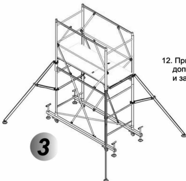
12. При необходимости, для придания вышке-туре дополнительной устойчивости, установить по углам и зафиксировать опоры-стабилизаторы (11)
