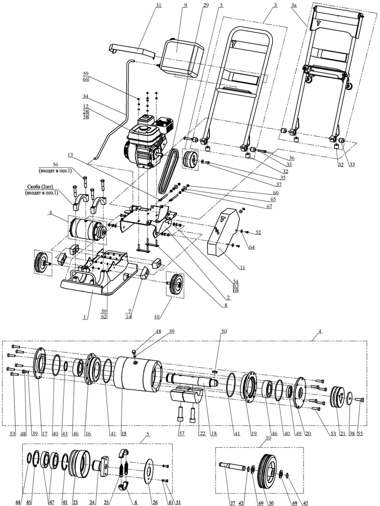
Рисунок 8 – Компоновка виброплиты
