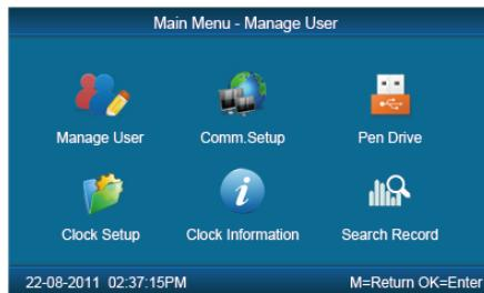
В **【Основном меню】**, нажмите цифровые клавиши или **【IN←】【OUT→】**, чтобы выбрать **【Управление пользователями】**, **【Настройки соединения】**, **【U-диск】**, **【Установки устройства】**, **【О системе】** и **【Поиск записей】**.
