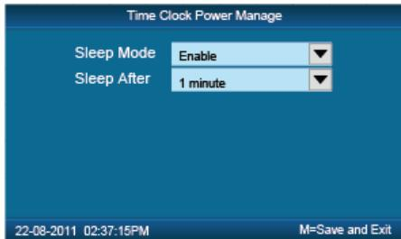
【Режим сна】: Включение/Выключение режима сна. Режим сна: Погасить дисплей/ Заставка
