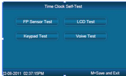
Тестирует следующие функции устройства: **【Проверка сенсора】**、**【Проверка экрана】**、**【Проверка клавиатуры】**、**【Проверка голоса】** .
