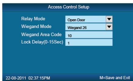
【Смена режима】: Настройка выхода реле на открытие двери или на звонок.
