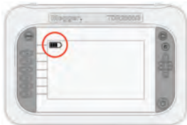
Состояние аккумуляторной батареи
