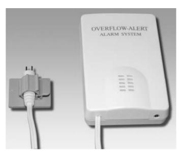
LD-63HS может использоваться в ванных комнатах, подвалах и других местах, где требуется определение возможных протечек воды. Извещатель питается от батареек. В случае обнаружения протечки воды, встроенная сирена выдает сигнал тревоги. Одновременно замыкаются Нормально Разомкнутые контакты реле, которые можно использовать для подключения извещателя к системе сигнализации. Пар или незначительные брызги воды не вызывают срабатывания устройства.
