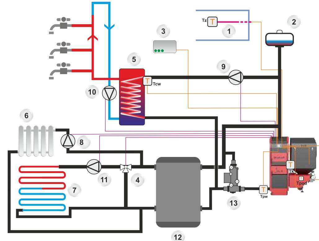
Рисунок 8.2.4 Подключение котла к отопительной системе с сладдоматом и буфером
