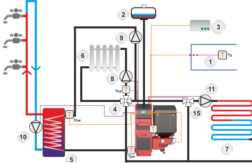
Рисунок 8.2.3 Подключение котла к отопительной системе
