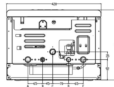
A: G3/4 Выход контура отопления
