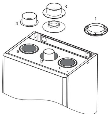
Изначально все газовые котлы оснащены переходником, для подключения коаксиальной системы дымоудаления (деталь 1 закрепленная на месте b). Отверстия для подключения раздельной системы (a и c) герметично закрыты.
