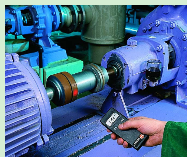
Измерения об/мин на насадках, валах с помощью testo 465
