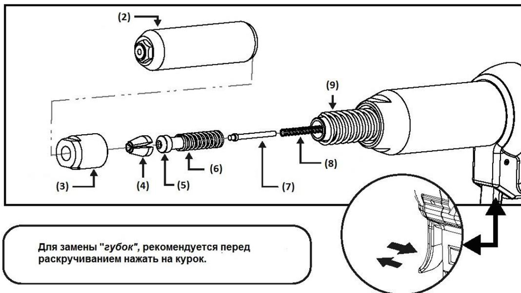
Разборка инструмента производится в следующей последовательности :
