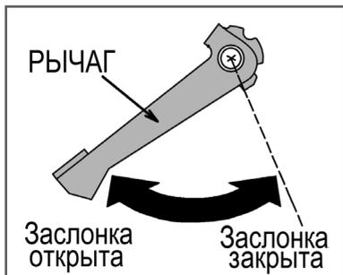
Рис. 14 Рычаг управления воздушной заслонкой PC5332F (вид сверху)
