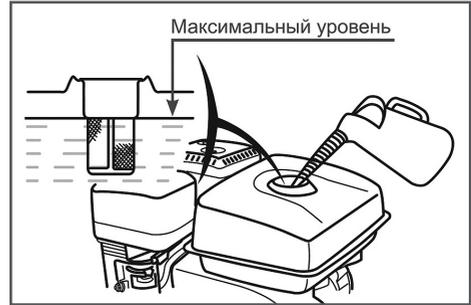
**Рис. 13 Максимальный уровень топлива в топливном баке**
