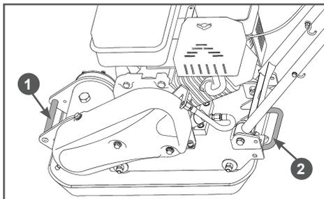
**Рис. 36 Рукоятки транспортировочные**
