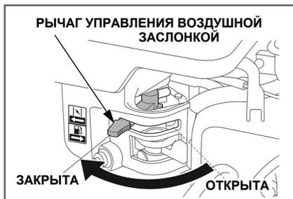
Рис. 15 Рычаг управления воздушной заслонкой PC6337F
