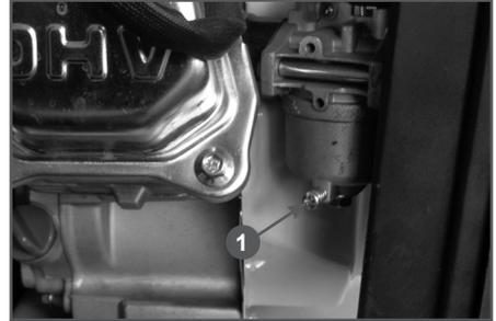
Рис. 24 Обслуживание фильтра-отстойника PC5332F
