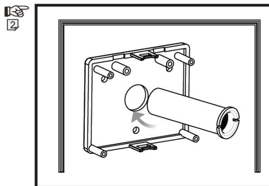
1. Просверлите отверстие диаметром 17 мм в двери, на высоте 1,4 – 1,7 метра. Вставьте камеру в дверь снаружи (рис.1), помните о правильном положении камеры, кнопка вызова должна быть внизу. Для удобства установки можно зафиксировать камеру двусторонним скотчем. Конструкция видеоглазка позволяет устанавливать его на двери толщиной 38 – 72 мм.
