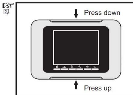
Нажмите кнопки фиксации монитора (сверху и снизу корпуса, см. рис.8 и 9), снимите монитор с кронштейна, потянув его на себя. Откройте крышку батарейного отсека, замените батареи (2 шт по 1,5 В AA) на новые. Закройте крышку батарейного отсека и установите монитор на кронштейн.
