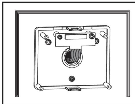
6. Закрепите кронштейн монитора тремя прилагаемыми шурупами (рис.6).
