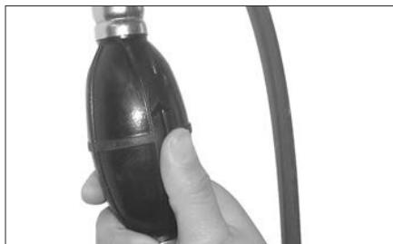
**Рис.2 Топливная помпа**
