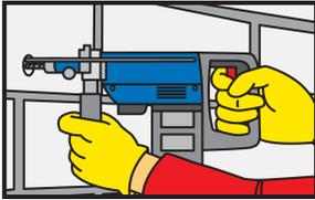
Просверлить отверстие необходимой глубины и диаметра при помощи перфоратора. Диаметр отверстия должен соответствовать размеру крепёжного элемента.
