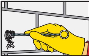
Отверстие следует тщательно очистить при помощи круглой щётки (не менее 2х раз). Диаметр щетки должен быть больше диаметра просверленного отверстия.
