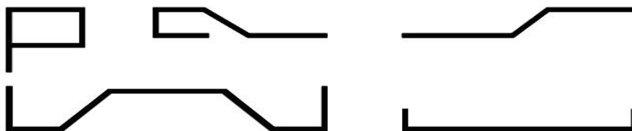
Рис. 5 Формы изгиба арматуры
