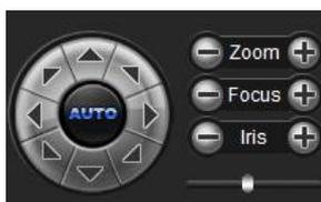
**Управление PTZ:** Вы можете использовать восемь кнопок со стрелками, чтобы повернуть интерфейсные устройства, и AUTO указывает автоматическое вращение. Zoom In / Out: Для регулировки степени увеличения / уменьшения
