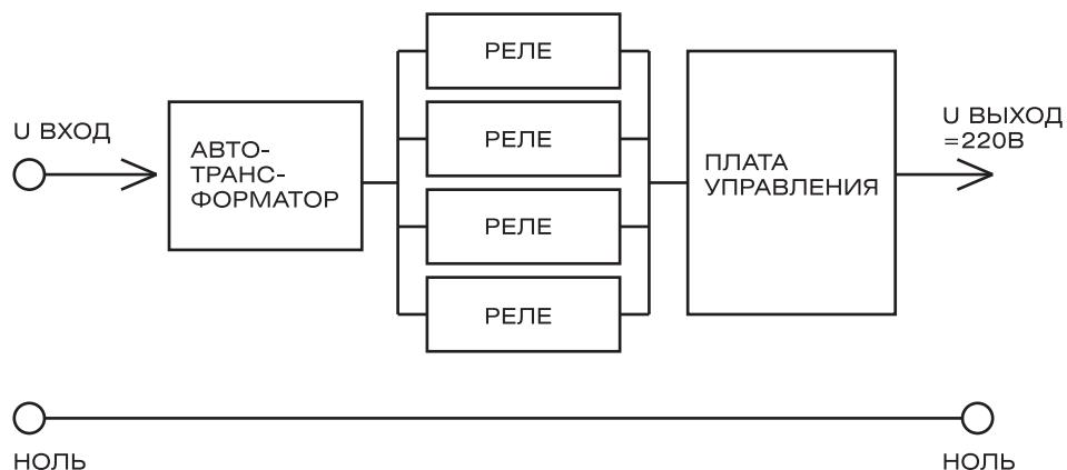
При включении стабилизатора входное напряжение поступает на автотрансформатор, далее электронные компоненты стабилизатора анализируют входное напряжение и, используя полученную информацию, плата управления включает поочередно силовые ключи (реле) до того момента, пока выходное напряжение стабилизатора не будет установлено в пределах, указанных в Таблице 2, после этого на выходные клеммы стабилизатора подается напряжение.
