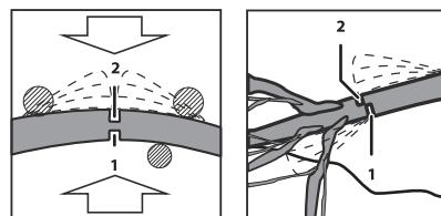
При разделке стволов, находящихся под натяжением, выполните сначала надпил (на глубину не более 1/3) с внутренней стороны изгиба, потом пропилите с внешней стороны.
