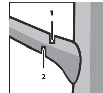
При обпиловуванні гілок, що знаходяться під натягненням, виконайте спочатку надпил (на глибину не більше 1/3) з внутрішньої сторони вигнути, потім пропилийте із зовнішнього боку.
