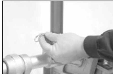
Насадить ручки на бобышки, расположенные на поворотном валу прижимной балки. Закрепить штифтами.
