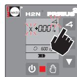
Přijmut hodnoty  $0.00\%$  tlačítkem nebo nastavení hodnoty, např.  $+5\%$  pro osu X, pomocí komfortních funkcí tlačítek
