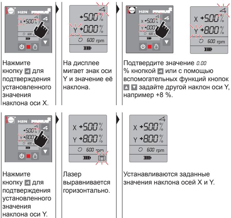
Нажмите кнопку для подтверждения установленного значения наклона оси X.
