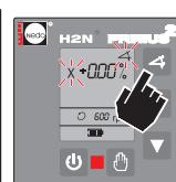
Подтвердите значение 0.00 % кнопкой или с помощью вспомогательных функций кнопок задайте другой наклон оси X, например +5 %.
