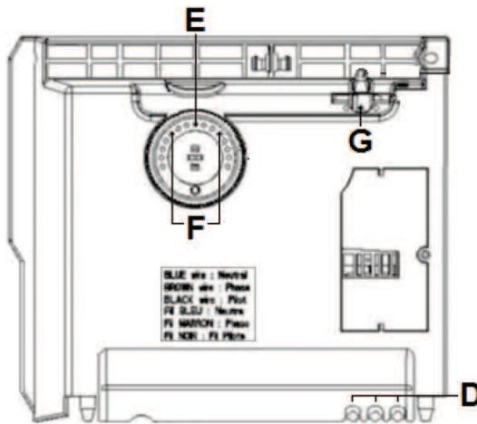
Za preprečevanje nepričakovanih sprememb v nastavitev lahko blokirate ali omejite regulator **C** in blokirate ročico **B**. V tem primeru odstranite napravo iz stenskega nosilca. Na zadnji strani ohišja termostata, odstranite zatiči **D**:
