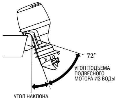
Подвесные моторы модели BF115A/130A оснащены сервоприводом регулировки наклона/подъема из воды, что позволяет выполнять регулировку наклона мотора как на ходу, так и на стоянке. Угол наклона подвесного мотора можно регулировать при равномерном движении лодки и при ускорении, для того чтобы добиться максимальных ходовых качеств при высокой топливной экономичности.
