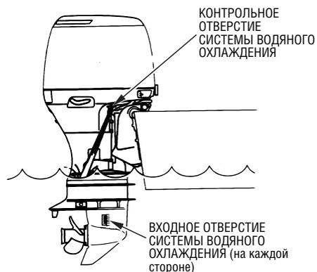
4. После пуска двигателя проверьте наличие водяной струи, вытекающей из контрольного отверстия. Расход воды, вытекающей из контрольного отверстия, может изменяться в зависимости от состояния термостата. Это является нормальным явлением.
