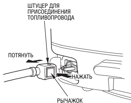
1. Нажимая на фиксирующий зажим штуцера, потяните за штуцер топливопровода и отсоедините топливопровод от подвесного мотора.
