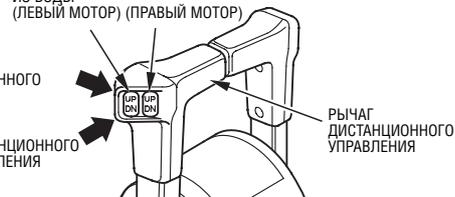
Регулировку наклона спаренных подвесных моторов можно выполнять синхронно - с помощью выключателя сервопривода, расположенного на рычаге дистанционного управления. Кроме того, левый и правый моторы можно регулировать по-отдельности, воспользовавшись для этого выключателем на консоли управления.
