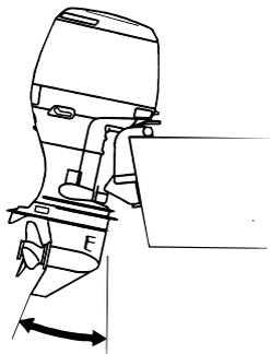
Конструкция подвесного мотора предусматривает пять возможных положений по углу наклона.
