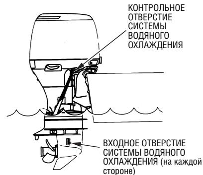
6. После пуска двигателя проверьте наличие водяной струи, вытекающей из контрольного отверстия. Расход воды, вытекающей из контрольного отверстия, может изменяться в зависимости от состояния термостата. Это является нормальным явлением.
