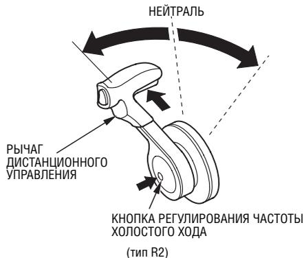
5. После пуска двигателя медленно переведите рычаг дистанционного управления в положение, которое обеспечивает устойчивую работу двигателя на холостом ходу, и удерживайте рычаг в этом положении.
