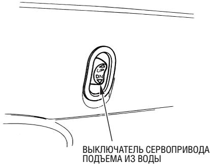
Если вы находитесь на удалении от поста дистанционного управления и не можете включить сервопривод подъема, то можно поднять подвесной мотор, воспользовавшись выключателем сервопривода, который расположен сбоку на подвесном моторе. Выключатели сервопривода подъема из воды, установленные на рычаге дистанционного управления и на самом подвесном моторе, функционируют аналогично.
