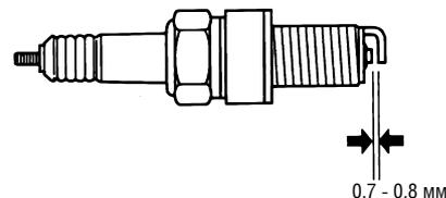
5. Измерьте с помощью плоского шупа зазор между электродами свечей зажигания. Величина зазора должна составлять 0,7 - 0,8 мм. При необходимости отрегулируйте величину зазора, осторожно подгибая боковой электрод.
