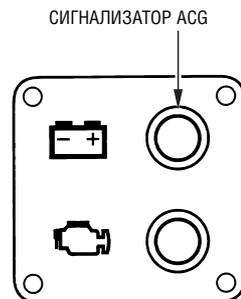
При неисправности системы энергоснабжения загорается сигнализатор ACG и включается зуммер.
