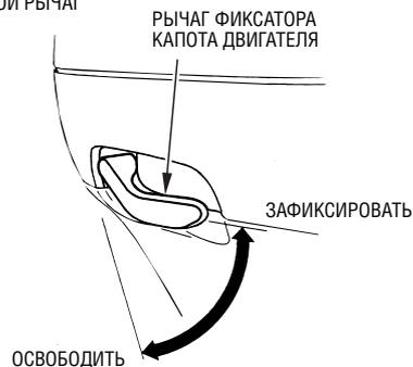
Для того чтобы снять капот двигателя или закрепить его после установки, соответственно, переведите рычаги фиксаторов в положение «ОСВОБОДИТЬ» или «ЗАФИКСИРОВАТЬ».
