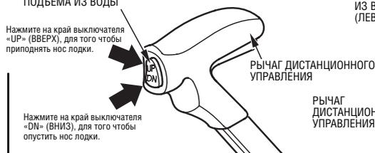
Сервопривод регулировки наклона/подъема из воды функционирует при нажатой клавише и отключается при отпускании клавиши. Для того немного приподнять подвесной мотор, нажмите на край клавиши «UP» (ВВЕРХ) - кратковременно, но достаточно сильно. Для того чтобы немного опустить подвесной мотор, нажмите на край клавиши «DN» (ВНИЗ), действуя аналогично.
