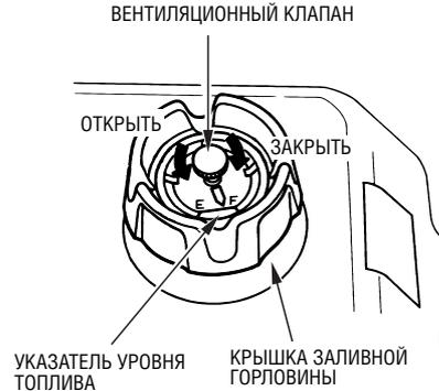
Вентиляционный клапан обеспечивает поступление воздуха в бак и выход паров топлива в атмосферу.
