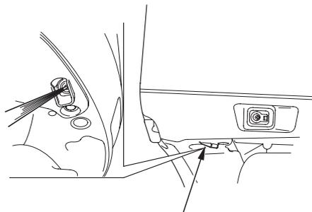
КОНТРОЛЬНОЕ ОТВЕРСТИЕ СИСТЕМЫ ВОДЯНОГО ОХЛАЖДЕНИЯ
